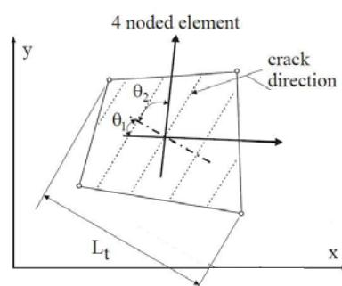
$\gamma = 1.0$  (scheur parallel aan element randen)
